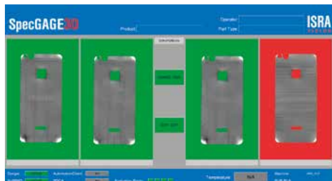
外观检查：对一个托盘中的几个组件进行多元件测量
